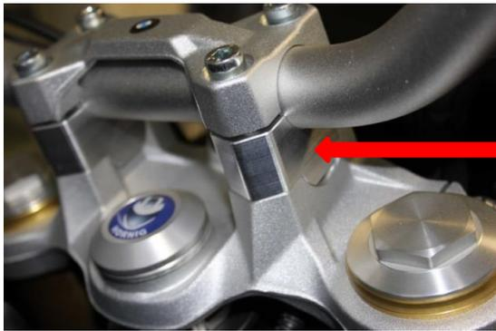
Lenker Demontage: Lösen der Verschraubung des Lenkers
