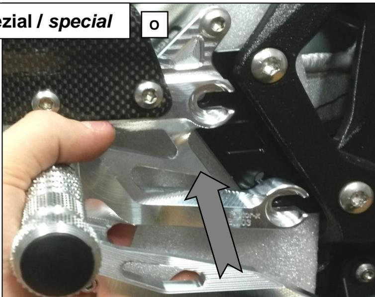
**O:** Die Rastenanlage kann zusätzlich auf der Zwischenplatte **FXR-HA-BM03** in der Höhe versetzt werden.
