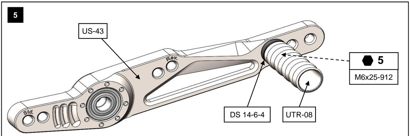
**5:** Schalthebel **US-43** mit den Angaben der Darstellung vormontieren:
