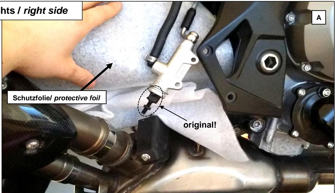
**A:** Originale Rastenanlage demontieren und Auspuff, sowie Schwinge durch Abdecken gegen Beschädigungen schützen.
