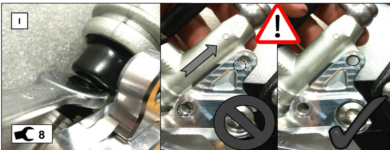
**I:** Drehen Sie die Betätigungsstange (Schlüsselfläche unterhalb der Gummimanschette) des Bremszylinders mittels Maulschlüssel 8mm hinein oder heraus, sodass die Bohrungen des Bremszylinders deckungsgleich mit den Bohrungen der Rastenanlage sind- **Beide in einer Flucht (anderfalls stimmt das Bremsenspiel nicht)**!
