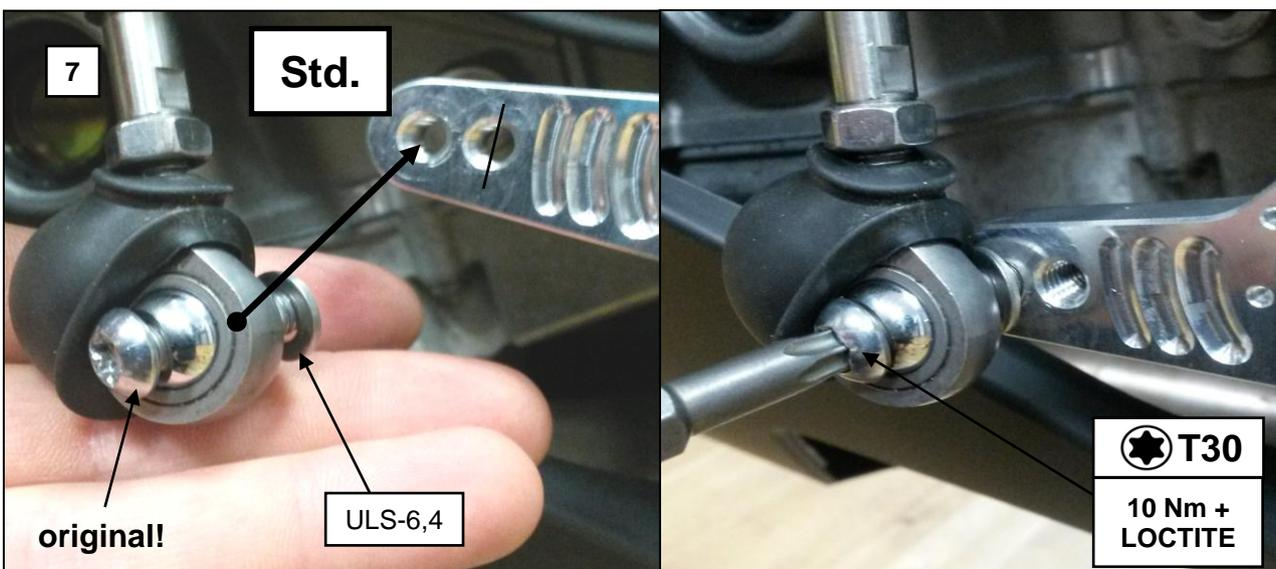
**7:** Montieren Sie den originalen Kugelkopf mittels der originalen Schraube von der Vorderseite an den Schalthebel. Unterlegscheibe **ULS-6,4** benutzen!
