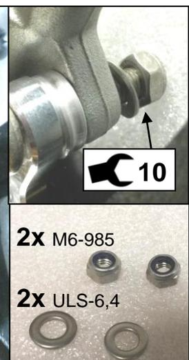
**K:** Fersenschützer mit der Schraube **M6x10-14583-VA-TX** am zweiten Haltepunkt anschrauben!
