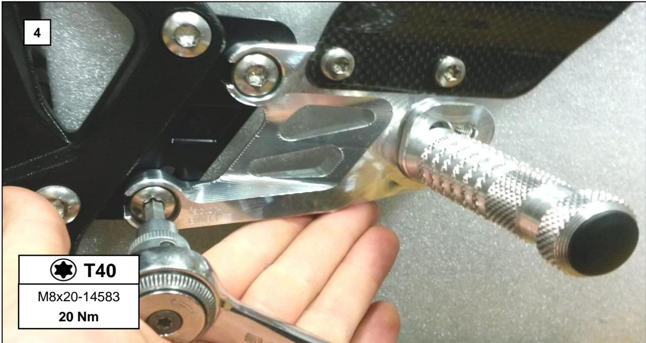
**4:** Setzen Sie die Rastanlage auf die Zwischenplatte **FXR-HA-BM03** und schrauben Sie diese fest. (Zwei Schrauben, **M8x20-14583-VA-TX**)
