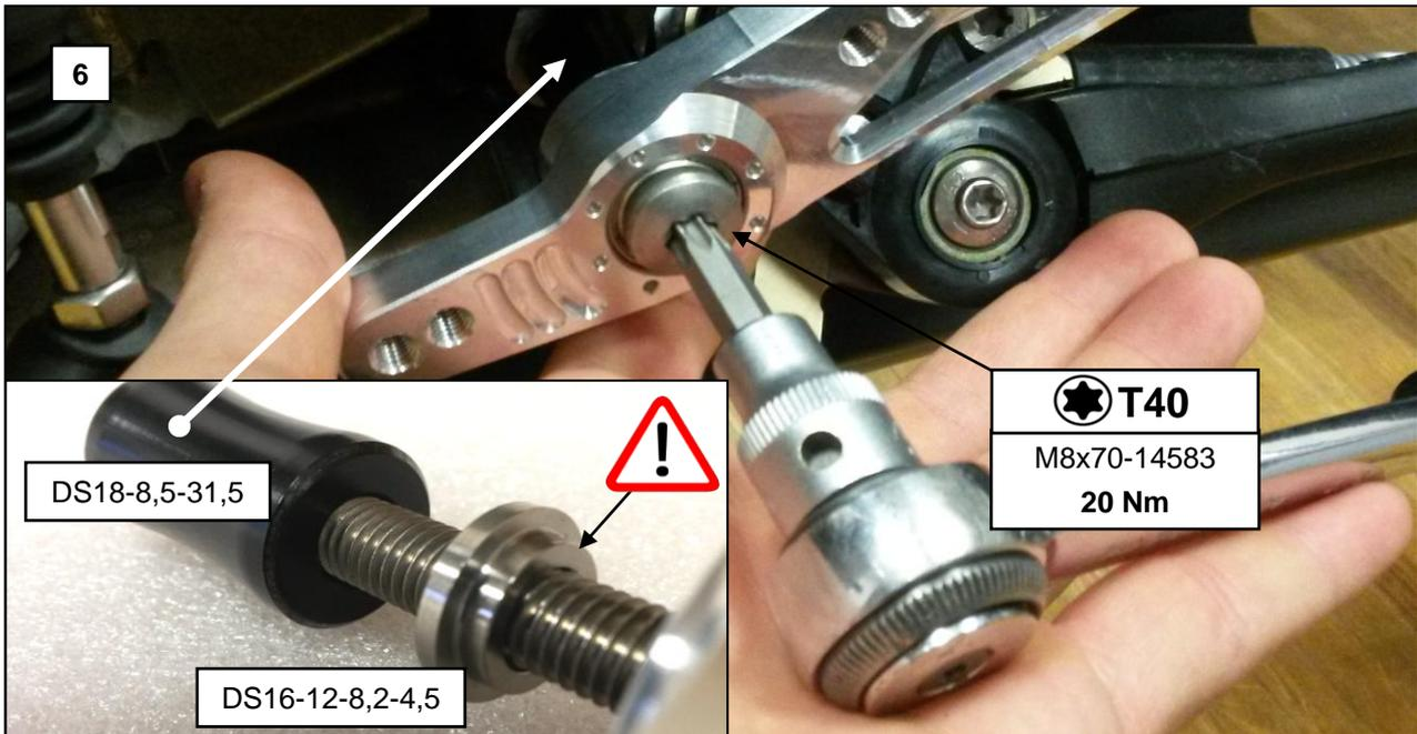
**6:** Montieren Sie den Schalthebel mit der angegebenen Distanzbuchse **DS18-8,5-31,5** und der Auflagescheibe **DS16-12-8,2-4,5** (Kleiner Bund- Ø in Richtung Rillenkugellager des Hebels) auf den Rahmen. Schraube **M8x70-14583-VA-TX** benutzen und festziehen!
