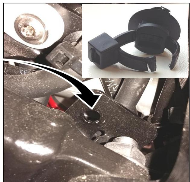
**B:** Entfernen Sie den dargestellten Kabelbinder an der Stahlflexbremsleitung um den Bremszylinder bei der Montage einfacher und weiter verrücken zu können.
